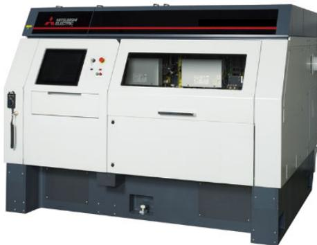
高出力深紫外ピコ秒レーザー加工装置の試作機
